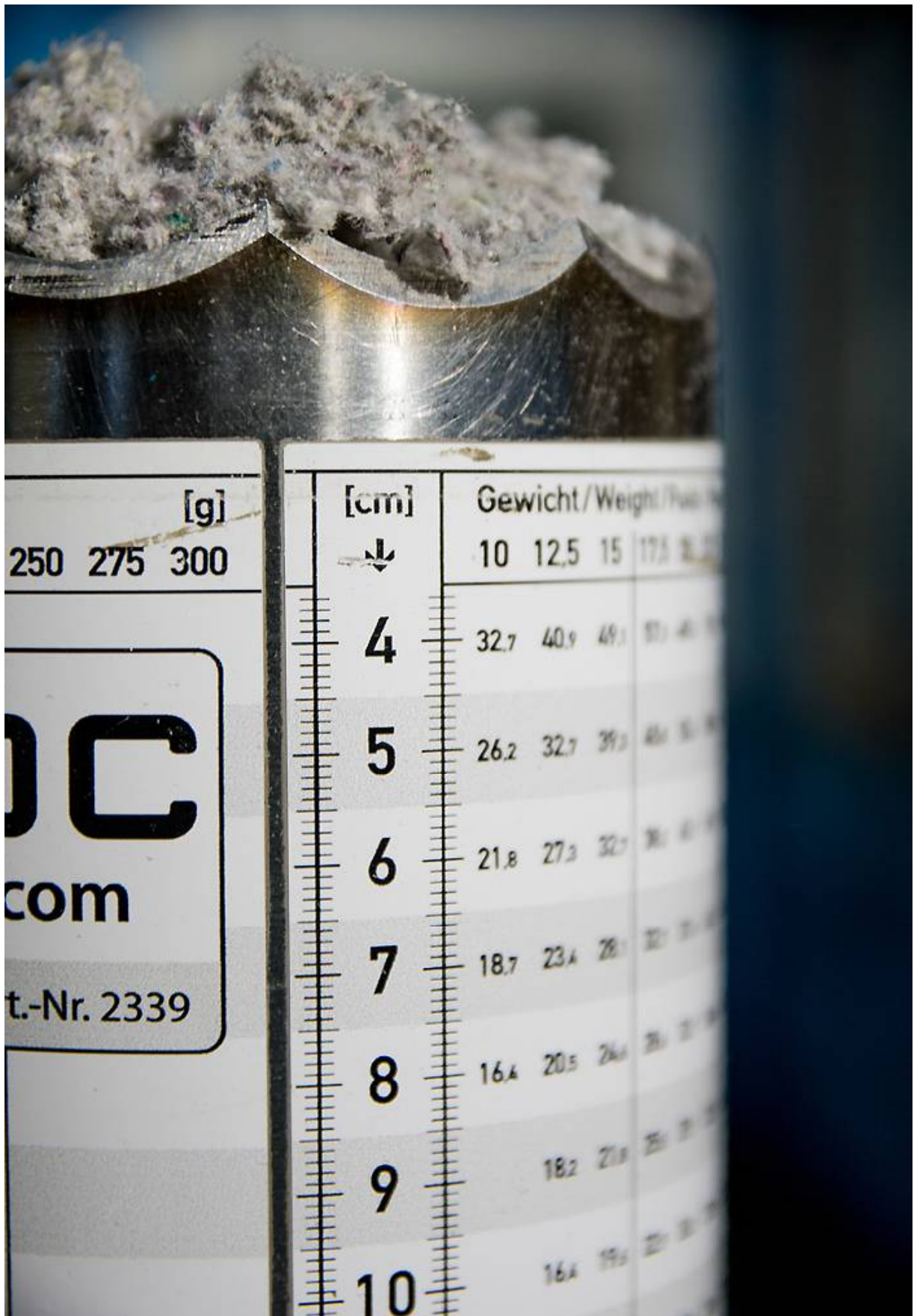
Lichtes Maß des Gefachs + Gewicht des Inahltes des Zylinders ergeben den KG Wert pro m3.
